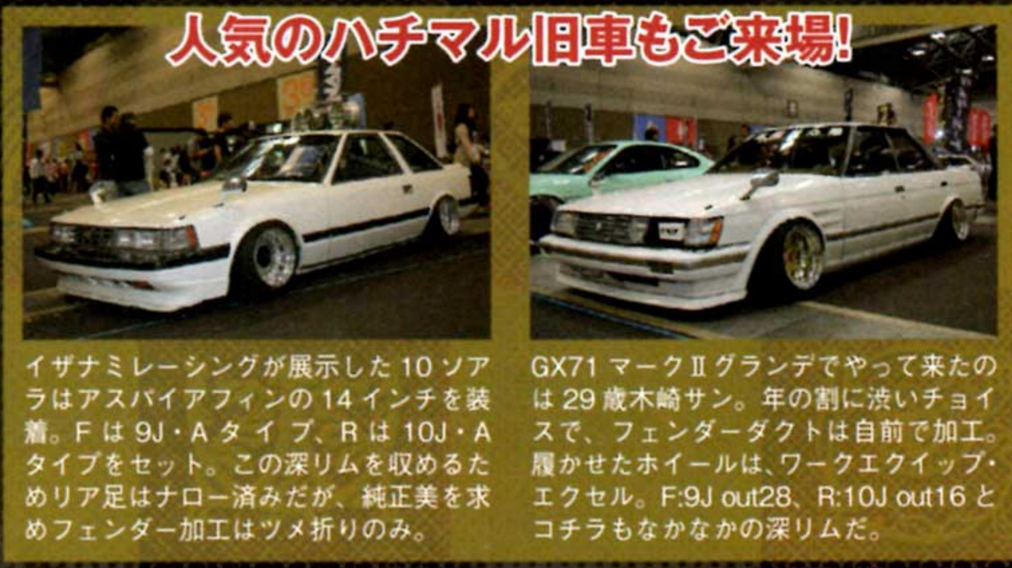
イザナミレーシングが展示した10ソアラはアスパイアフィンの14インチを装着。Fは9J・Aタイプ、Rは10J・Aタイプをセット。この深リムを収めるためリア足はナロー済みだが、純正美を求めるフェンダー加工はツメ折りのみ。
