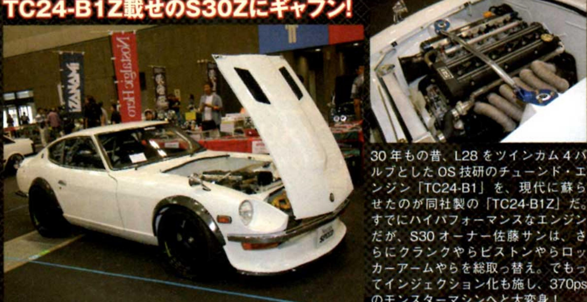
30年もの昔、L28をツインカム4バルブとしたOS技研のチューンド・エンジン「TC24-B1」を、現代に蘇らせたのが同社製の「TC24-B1Z」だ。すでにハイパフォーマンスなエンジンだが、S30オーナー佐藤さんは、さらにクランクやらピストンやらロッカーアームやらを総取替え。でもってインジェクション化も施し、370psのモンスターマシンへと大変身！
